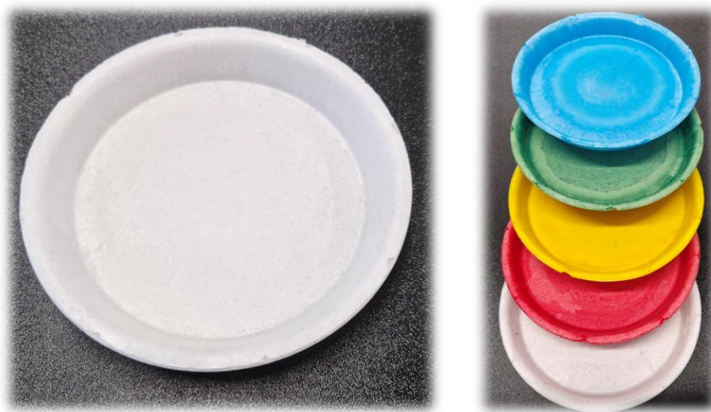
Rys. 16. Zdjęcie przykładowych tacek wyprodukowanych z dodatkiem skrobi grochowej i barwionych w masie
